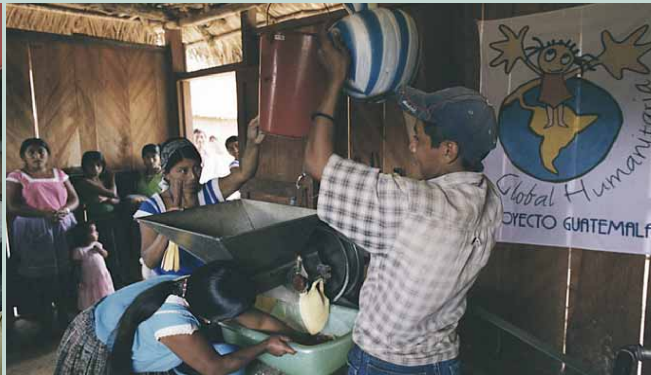
Funcionamiento del molino de nixtamal de Las Flores Machaca III, utilizado por toda la comunidad. Juan Díaz / Global Humanitaria [Fotos]
